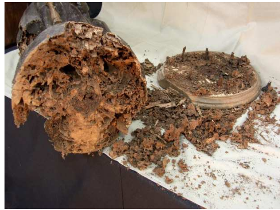
Remoção de excreções das térmitas e de restos da madeira danificada pela sua acção.
