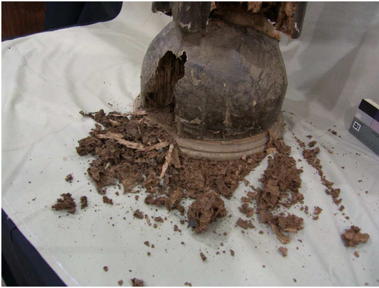
Remoção de excreções das térmitas e de restos da madeira danificada pela sua acção.
